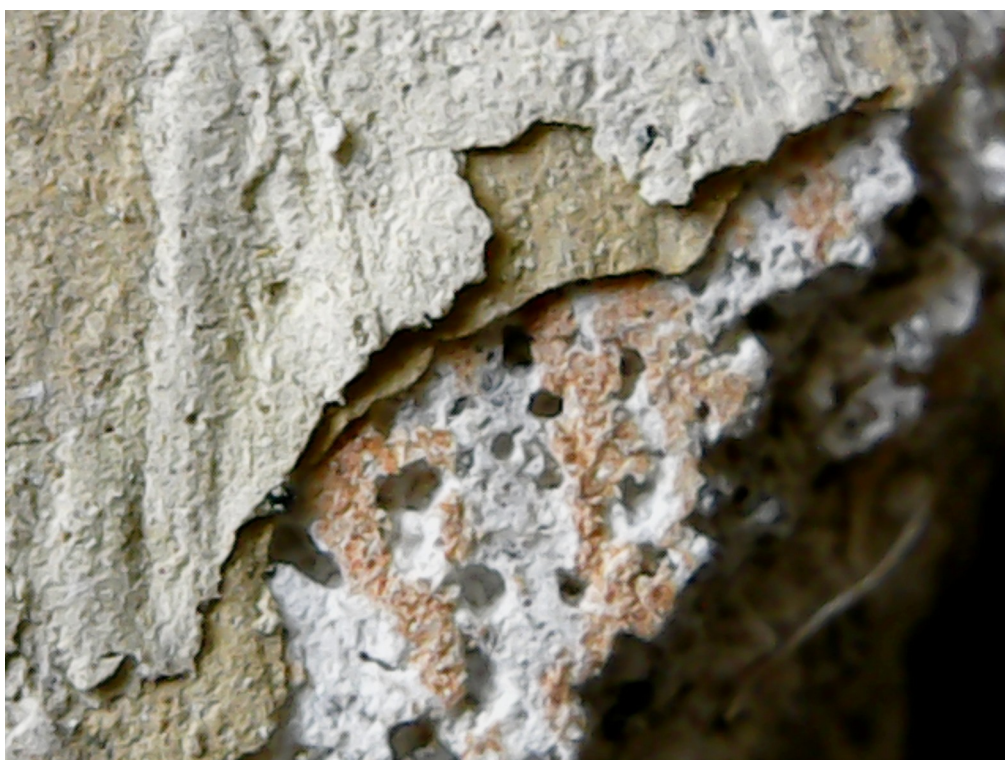
fot. 11: Zdjęcie mikroskopowe próbki pobranej w miejscu odkrywki nr 21. Widoczne odkryte warstwy malatury.
